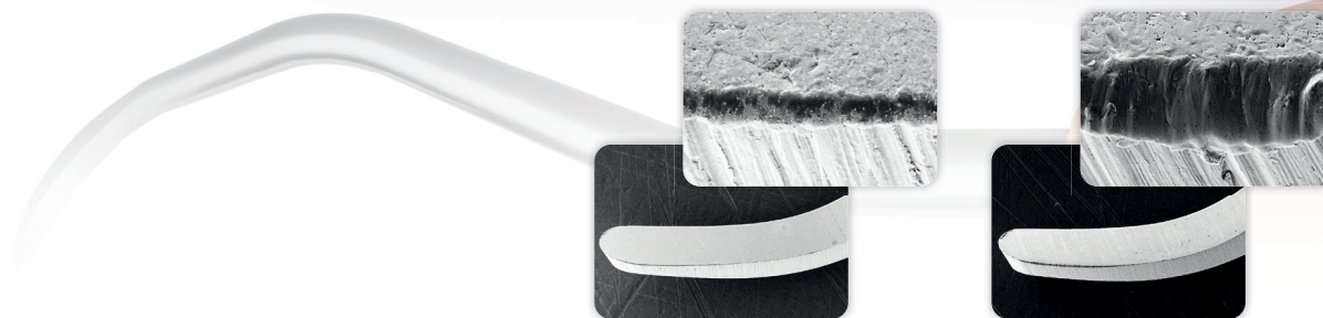
Die Schneide der LM Sharp Diamond™ Kürette und Vergrößerung der Kante nach dem Test.
